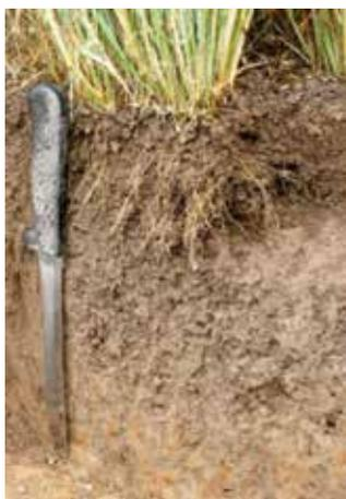
*La profundidad efectiva de las raíces se extiende hasta la punta del cuchillo; allí el suelo está sumamente compacto y firme sin raíces o canales de raíces viejas, ninguna galería de lombrices de tierra y sin ninguna fisura o grieta por donde las raíces puedan penetrar.*
