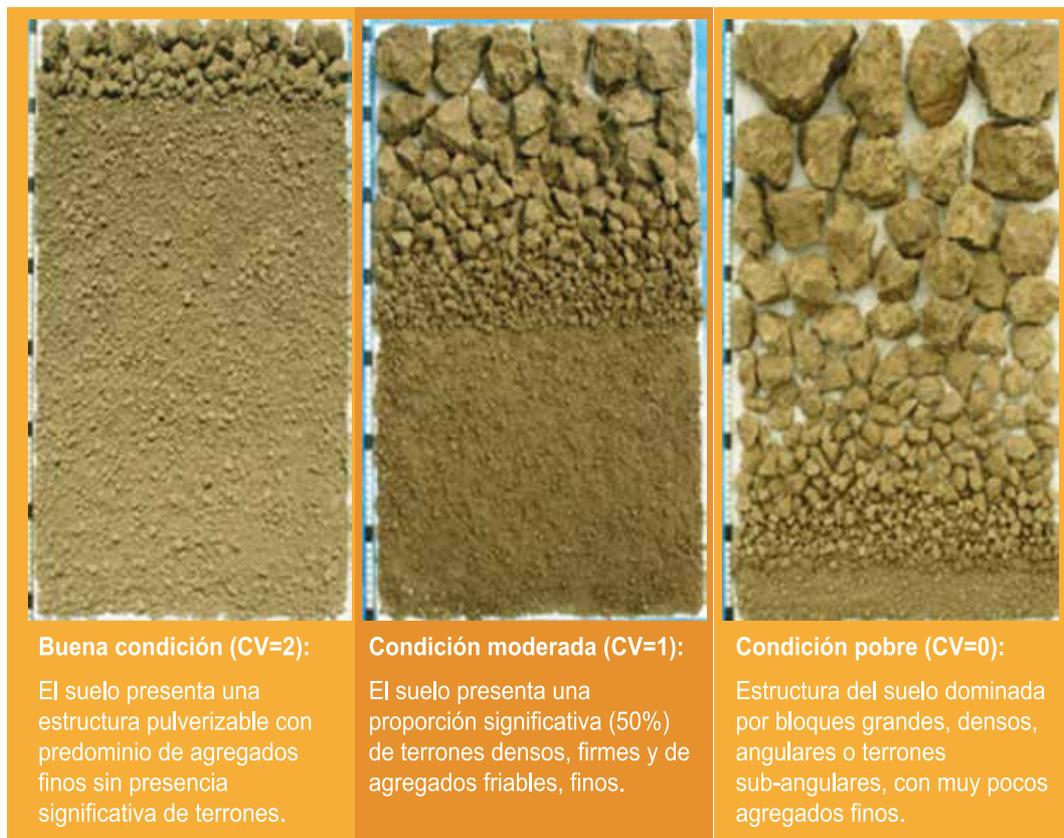
**Figura 1.** Parámetro de comparación para evaluar visualmente la estructura y consistencia del suelo
